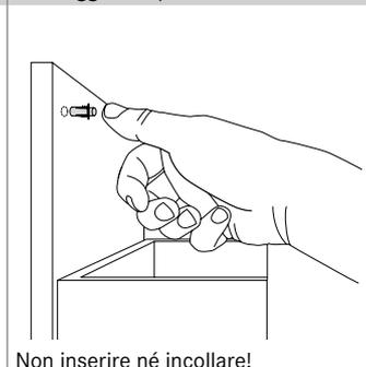
Montaggio del cavo di sincronizzazione
